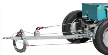
linka stalowa o średnicy \varnothing 6\text{ mm}
