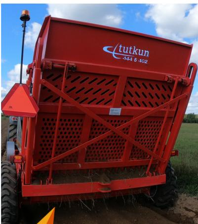
Die Konstruktion der Heckwand des Sammlers ermöglicht eine sehr effektive Separation der gesammelten Steine von der Erde.
