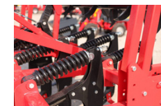
Podwójne zabezpieczenie sprężynowe NON-STOP
