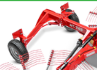
wysoka stabilność dzięki dużej szerokości wózka
